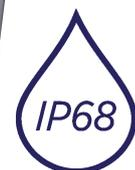
Il controller è certificato secondo lo standard IP68, totalmente protetto dal contatto con la polvere e resistente all'immersione a più di un metro di profondità.
