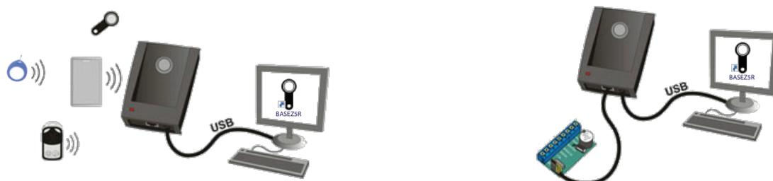
Il dispositivo USB supporta chiavi **iButton, Badge, Tag, radiocomandi 433 MHz** e **controller Z-5R**, permettendone una immediata comunicazione da e verso il PC su cui è installato BASEZ5R.
