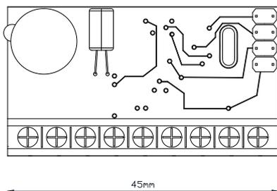
Il controller **Z-5R** ha un'unica uscita 12V DC per il collegamento al relè (incluso) e un ingresso per il lettore di chiavi a contatto iButton-Dallas. Il controller è posizionabile nelle pulsantiere di piano, di cabina o dislocabile su tetto cabina, comunque entro 15m dal lettore.
